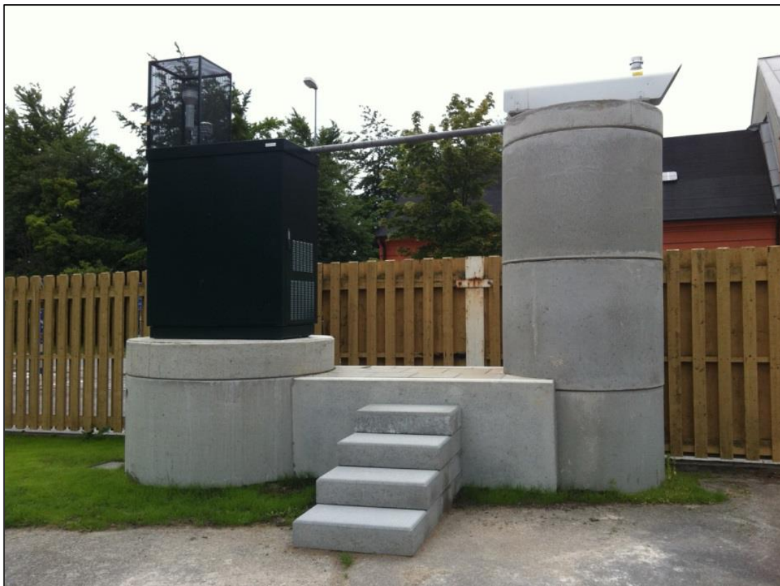
Figur 2. Mätstationen på Trollebergsvägen i Lund som består av partikelmätare och DOAS.
