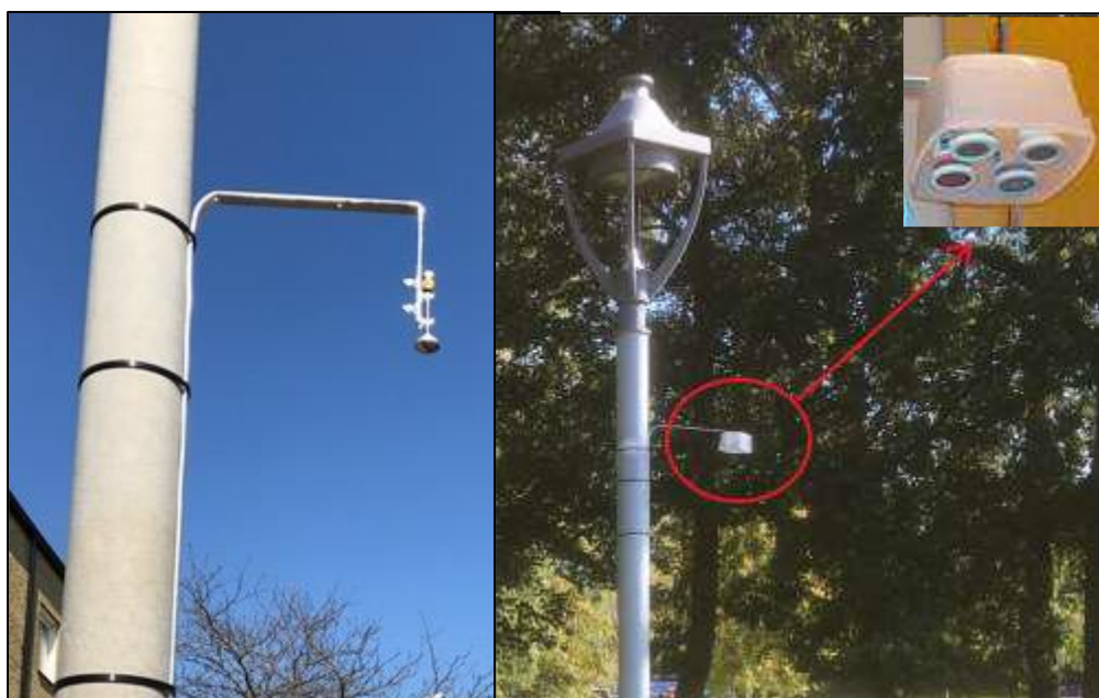
Figur 7. Placering av passiva provtagare för VOC samt NO 2 och NO x .
